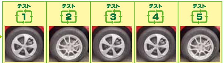
テスト1: 純正装着タイヤ + 純正ホイール テスト2: 純正装着タイヤ + エコフォルムSE10 テスト3: エコピアEX10 + 純正ホイール テスト4: エコピアPZX + 純正ホイール テスト5: エコピアPZX + エコフォルムSE10
